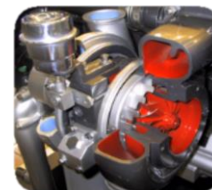
Первая турбина с изменяемой геометрией
