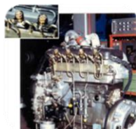
Первый двигатель с Common Rail для автомобилей
